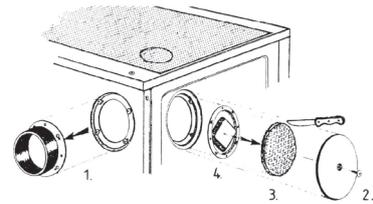
Beiliegende Abdeckung (ohne Mittelloch) an die Rückwand schrauben, Abgasstutzen seitlich anschrauben.
