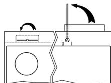
**Heiz- und Kochbetrieb:** Durchheizklappe schließen (mit Durchheizschlüssel auf 0 stellen) Abgasklappe wird automatisch geöffnet.
