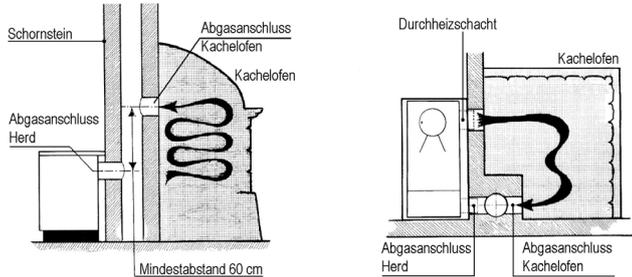
**HINWEIS:** Bei ZEH - Herden mit Durchheize entfallen die Anschlussmuffen für VL/ RL an der Rückseite. Der VL/ RL - Anschluss muss seitlich erfolgen!
