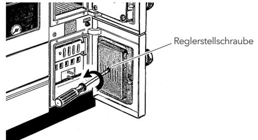
Beim Eindrehen der Stellschraube wird der Zuluftquerschnitt verringert, ein langsamerer, sparsamer Abbrand erfolgt.
