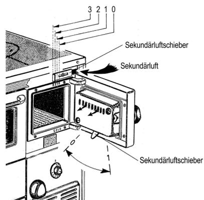
Beim Sekundärlufthebel an der Heiztürrinnenseite sind die Einstellungen wie beim Sekundärluftschieber durchzuführen, wobei hier die Hebelstellung 1 der Schieberstellung 3 von oben entspricht.
