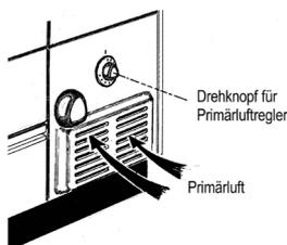
In Stellung „0“ ist die Luftreglerklappe geschlossen, in jeder anderen Stellung (1-6) unterschiedlich weit geöffnet. Regelmäßiges Entleeren der Aschenlade ist wichtig, da z. B. ein bis zum Rost ragender Aschenkegel die Primärluftzufuhr behindern würde.
