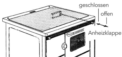
**HINWEIS:** Die Anheizklappe darf nur in der Anheizphase geöffnet bleiben. Eine während des Heizbetriebes offen stehende Anheizklappe führt zur Überhitzung des Herdes und damit zu Schäden an Herdteilen. Außerdem hat eine offen stehende Anheizklappe erhöhten Brennstoffverbrauch zur Folge.
