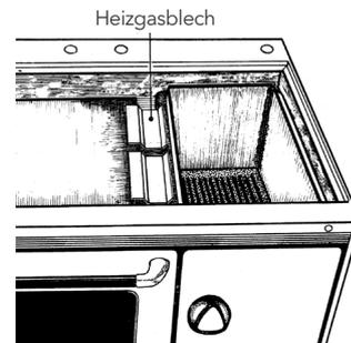
Dadurch werden die Heizgase vermehrt um das Backrohr herum gelenkt, eine gleichmäßige Temperaturverteilung im Backrohr ist die Folge. Nach Reinigungsarbeiten ist darauf zu achten, dass die Heizgasbleche wieder wie ursprünglich eingelegt werden.
