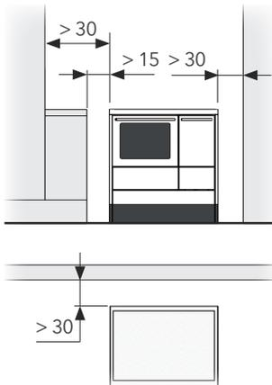
Bei Anbau an brennbare Materialien bzw. Einbau in eine Küchenzeile oder Anbau an einen E-Herd oder ein anderes Gerät ist eine Brandschutzeinheit (BSE, als Zubehör erhältlich) vorzusehen. Maximale Höhe der angebauten Einrichtungsgegenstände entspricht hierbei der Herdhöhe. Einrichtungsgegenstände über Herdhöhe müssen mind. 30 cm entfernt sein.
