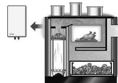
Bei **unterster Roststellung** (Füllfeuerung) erfolgt maximale Wärmeabgabe an die Heizung, die Kochleistung ist ausreichend, die Backleistung geringer.
