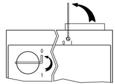
**Heiz- und Kochbetrieb:** Durchheizklappe schließen (mit Durchheizschlüssel auf 0 stellen) Abgasklappe separat schließen!
