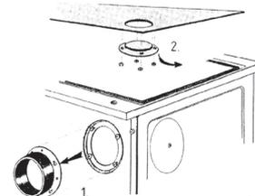
Abgasstutzen an die Kochplatte anschrauben, Beiliegende Abdeckung (ohne Mittelloch) an die Rückwand schrauben.
